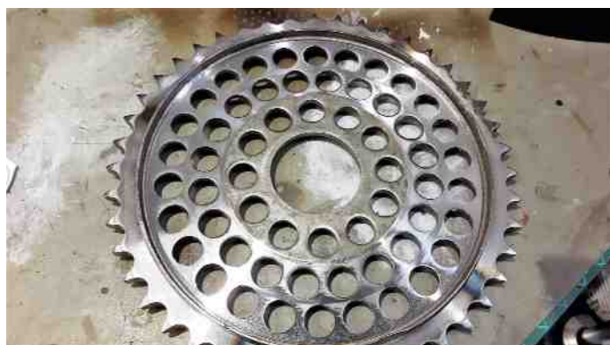
De oude kurkjes zijn verwijderd en de koppelingsplaat is voorberekt.
