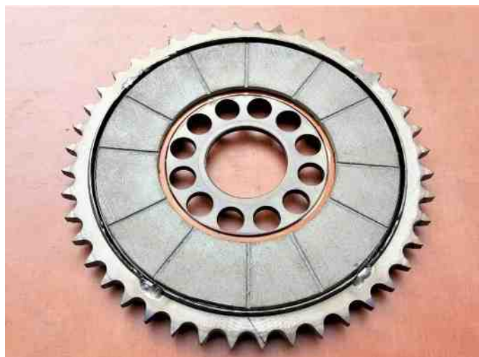
Het kevlar is aangebracht (aan beide kanten van de plaat).
