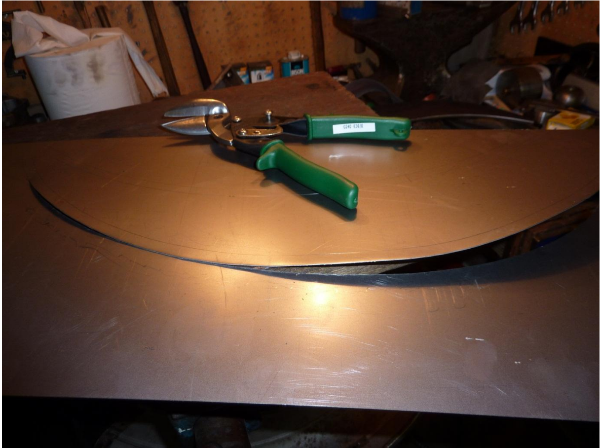
Het 0,8 mm milde plaatstaal wordt uitgeknipt...
