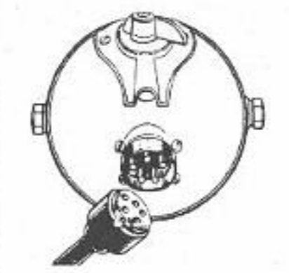
De bovenste tekening geeft, van boven af gezien, de spreiding van de lichtstraal aan. Daaronder de vijfpolige stekker, die vooral de wedrijdrijder zal appreciëren.
