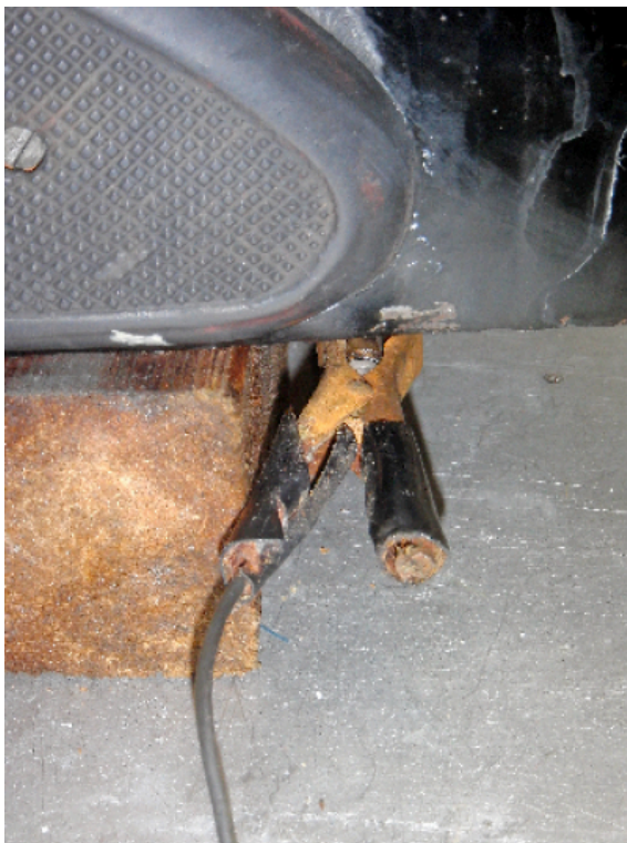
Koppel de eerste klem aan de benzinekraan.
